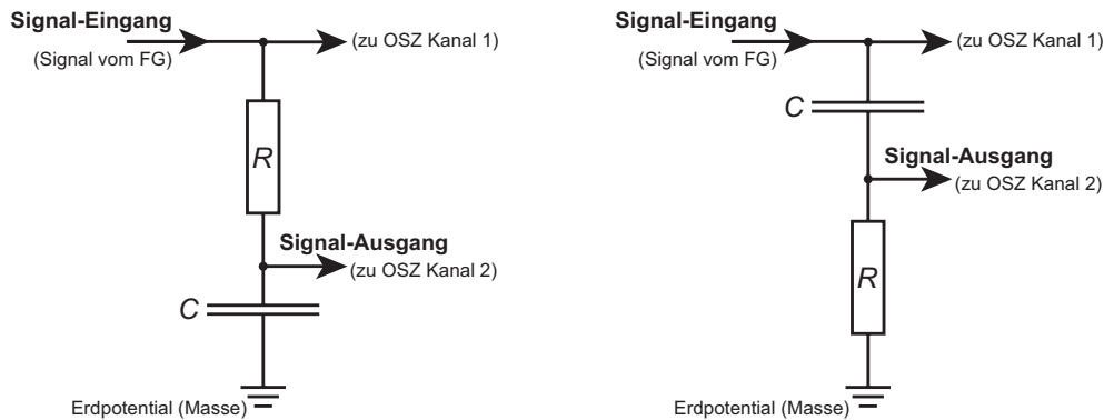
Abbildung 4.1: Links: RC-Tiefpass / Rechts: RC-Hochpass
