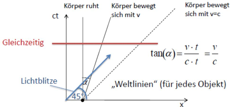
Abbildung 1: Minkowskidiagramm mit verschiedenen Weltlinien. Eingezeichnet sind die eines ruhenden und eines bewegten Körpers. Die des ruhenden verläuft parallel zur  $ct$ -Achse. Die des bewegten Körpers steht in einem gewissen Winkel  $\alpha$  dazu. Für die Propagation von Licht ist der Winkel zur  $ct$ -Achse  $45^\circ$ .
