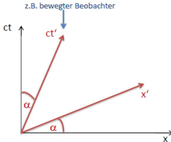
Abbildung 2: Minkowskidiagramm mit ct'- und x'-Achsen eines bewegten Bezugssystems
