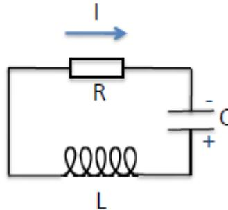
Abbildung 1: Schwingkreis bestehend aus Kondensator, Spule und Widerstand. Man nennt diese Schaltung auch LRC-Glied
