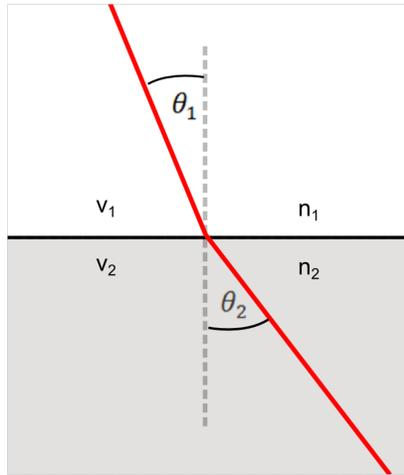
Abbildung 6: Graphische Darstellung des Snelliusschen Brechungsgesetzes. Der Weg eines Lichtstrahls durch eine Grenzfläche zweier dielektrischer Medien ist rot eingezeichnet.
