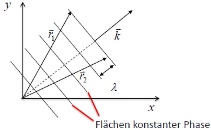
Abbildung 5: Der Wellenvektor  $\vec{k}$  steht senkrecht auf Flächen gleicher Phase. Die Wellenlänge  $\lambda$  entspricht dem Abstand phasen-gleicher Flächen.
