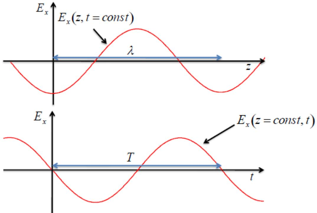
Abbildung 4: Im ersten Graphen ist das E-Feld gegen die Ausbreitungsrichtung aufgetragen, im zweiten gegen die Zeit. Man erkennt, dass die Funktion in beiden Parametern gleichermaßen periodisch sein muss.
