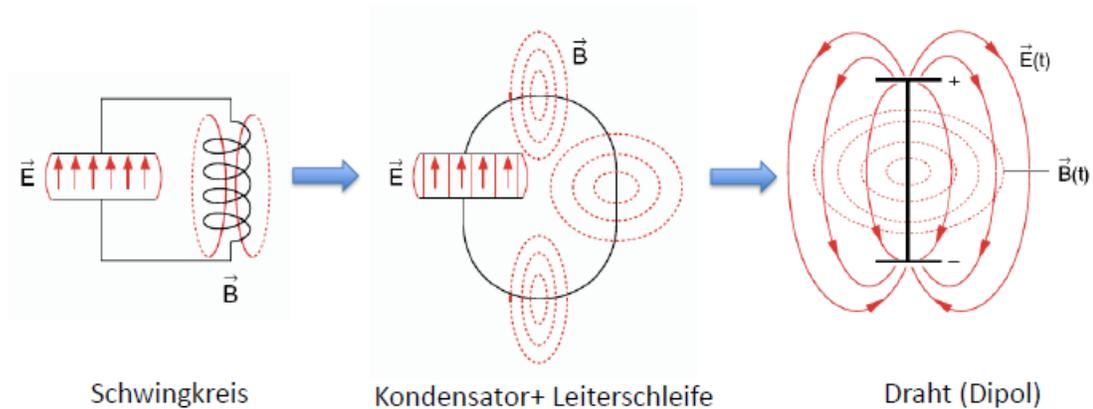
Abbildung 3: Darstellung der Überführung eines Schwingkreises in einen Hertz'schen Dipol
