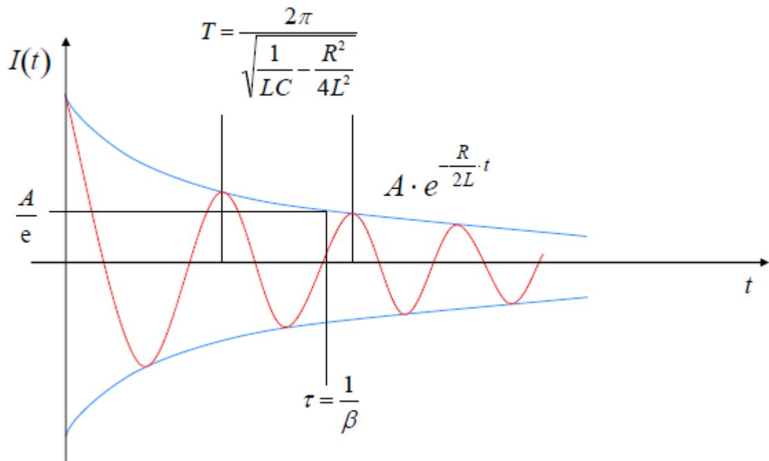
Abbildung 2: Der gedämpfte Schwingkreis. Die rote Funktion zeigt den tatsächlichen Verlauf der Stromamplitude. Die blaue Funktion verdeutlicht die Einhüllende, die durch den exponentiellen Abfall zustande kommt
