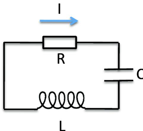
Abbildung 2: Schwingkreis mit Widerstand  $R$ , Kapazität  $C$ , Induktivität  $L$
