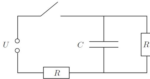
Abbildung 5: Spannungsnetzwerk
