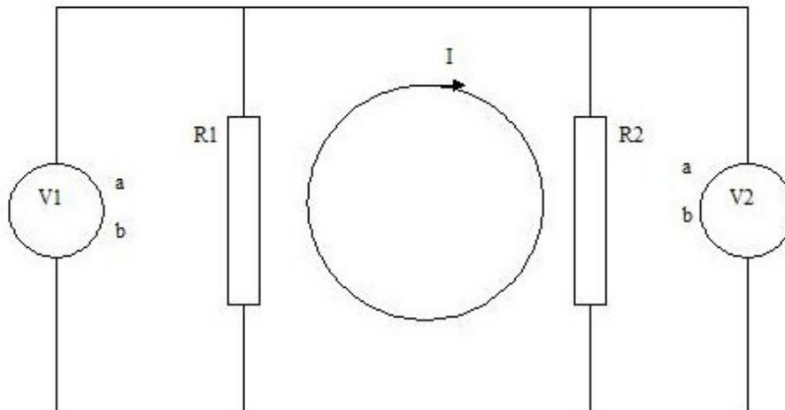
dass der magnetische Fluss  $\Phi(t) = \alpha t$  ist. Die beiden Spannungsmessgeräte  $V_1$  und  $V_2$  messen das Integral  $\int_a^b \vec{E} \cdot d\vec{l}$ . Berechne die Spannungen an den Widerständen  $R_1$  und  $R_2$ . Die Spannungsmessgeräte sind ideal, es fließt also kein Strom durch sie hindurch.
