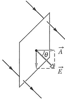
Abbildung 3: Veranschaulichung des elektrischen Flusses durch eine Oberfläche.
