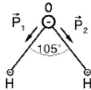
Abbildung 5: Das Wassermolekül als elektrischer Dipol.
