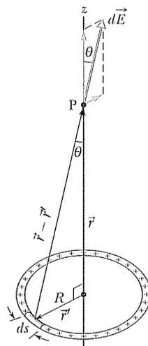
1. Passende Ladungsdichte: Ring mit Radius  $R$  und Gesamtladung  $q \Rightarrow$  Längenladungsdichte  $\lambda = \frac{q}{2\pi R} \Rightarrow$  Ladungselement  $dq = \lambda ds$ . Infinitesimales Feldelement:
