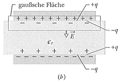
Abbildung 7: Plattenkondensator mit Dielektrikum.
