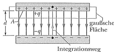
Zur Bestimmung der Kapazität nach  $C = q/U$  bestimmen wir zunächst die Ladung über den Satz von Gauß: Wir legen eine Gauß'sche Fläche um die positiv geladene Platte und integrieren:
